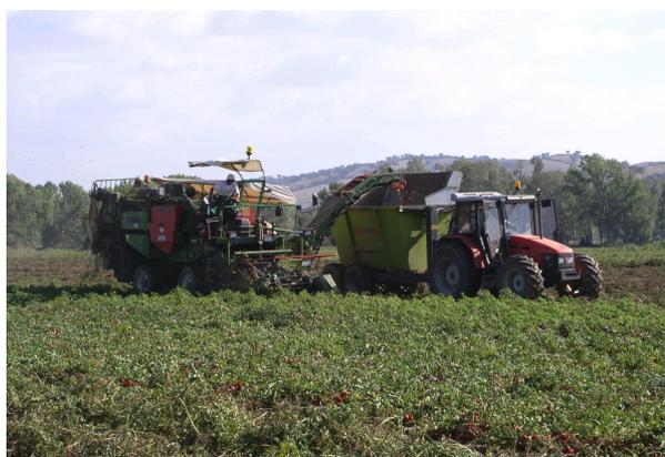
La macchina scarica in continuo il prodotto raccolto in contenitori trasportati da un trattore che avanza parallelamente.
